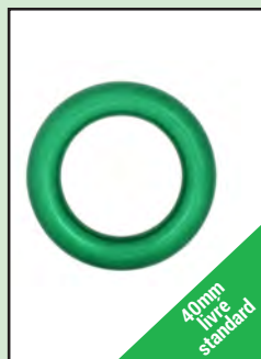
RD1 ANNEAU DMM » Norme: EN795B » en aluminium » charge minimale de rupture: 30kN » anodisé » chaque anneau est prévu d'un numéro de série individuel.
