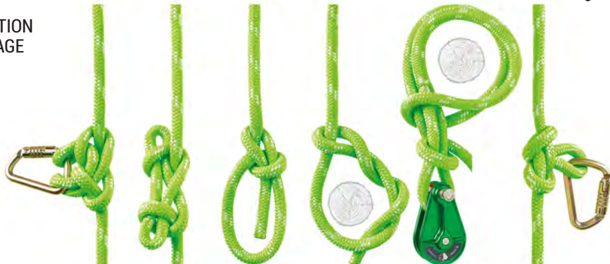
Noeud de jambe de chien avec mousqueton
